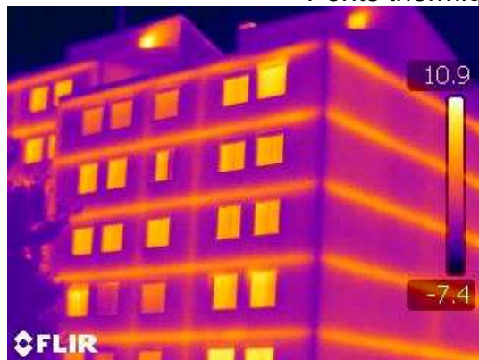
Ponts thermiques des dalles d'étages.
