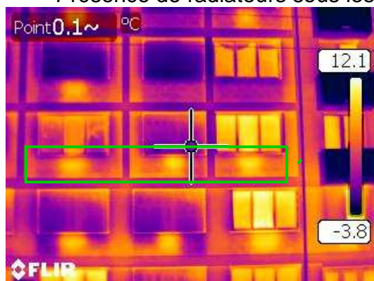
Présence de radiateurs sous les fenêtres (allèges non isolées).
