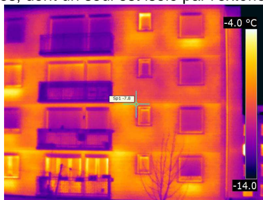
Thermographie de 2 bâtiments identiques, dont un seul est isolé par l'extérieur.
